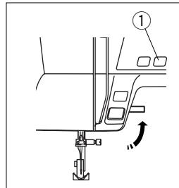
Stellen Sie den Nähfuß hoch. Drücken Sie die Taste Nadel Hoch/Tief ①, um den Fadenhebel in seine höchste Stellung zu bringen.
