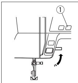
Relevez le pied de biche. Appuyez sur la touche de position haute/basse de l'aiguille 1. afin de relever le levier releveur de fil jusqu'à sa position la plus haute.
